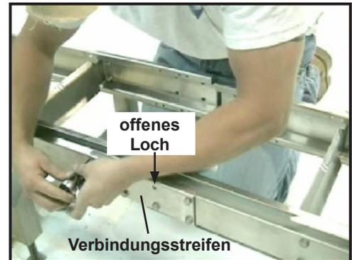
**Abbildung 5:** Ziehen Sie die ersten vier Schrauben fest.
