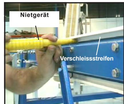
Abbildung 17: Niete anbringen, um den Verschleissstreifen zu befestigen
