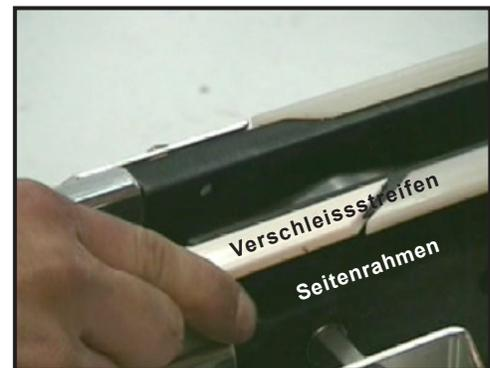
Abbildung 14: Verschleissstreifen in den Seitenrahmen schieben
