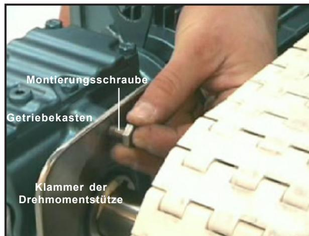
Abbildung 39: Vier Montierungsschrauben montieren und festziehen
