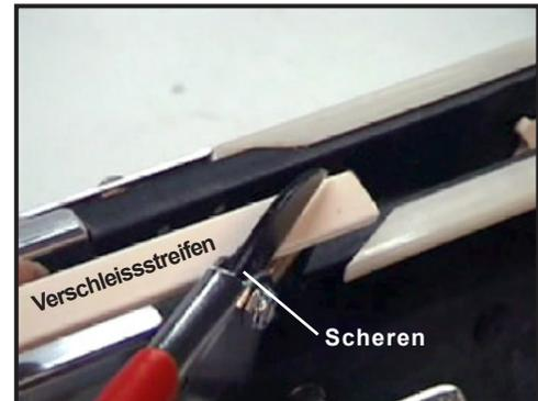
Abbildung 13: Den Verschleissstreifen in einem 60° Winkel schneiden
