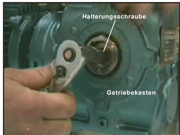
Abbildung 42: Halterungsschraube entfernen
