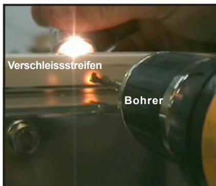
Abbildung 15: Licht anwenden, um das Loch ausfindig zu machen; ein Loch in den Verschleissstreifen bohren
