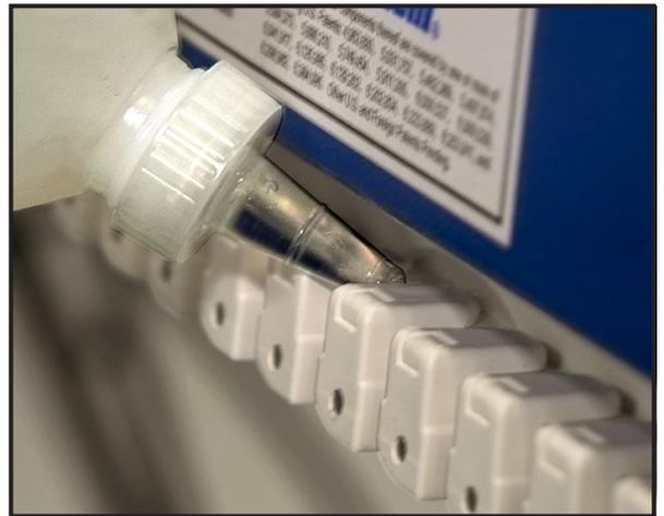
Schmieren Sie den Verschleissstreifen des Förderbands mit Silikonöl ein
