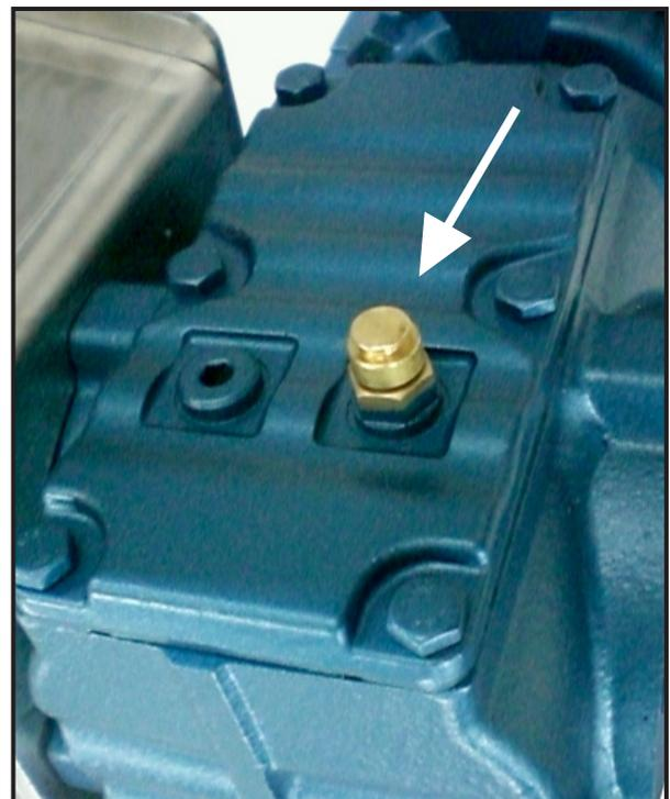
Abbildung 49: Entlüftungsventil
